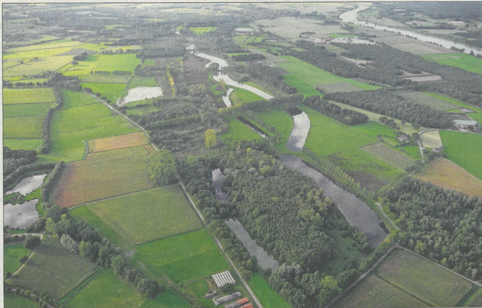
De buffer langs de Maas tussen Ooijen en Wanssum houdt water vast als het erg droog is en voert het af als het heel nat is. foto Johan Roerink/Aeropicture
